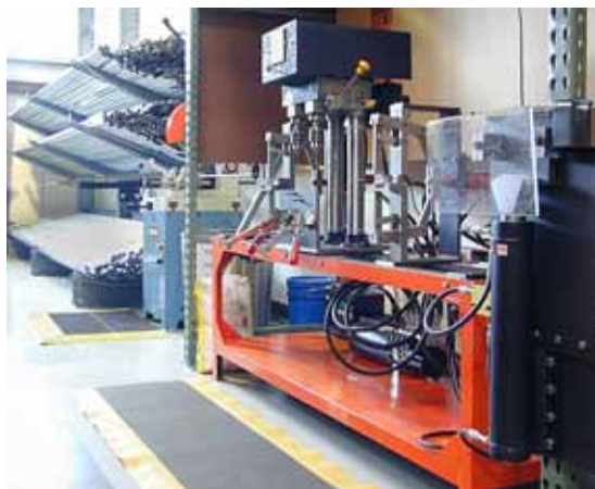
Une cellule ergonomique et mécanisée a été conçue par AME pour son nouveau système d'essuie-glace innovateur à Deux Pivots, le 2P.
