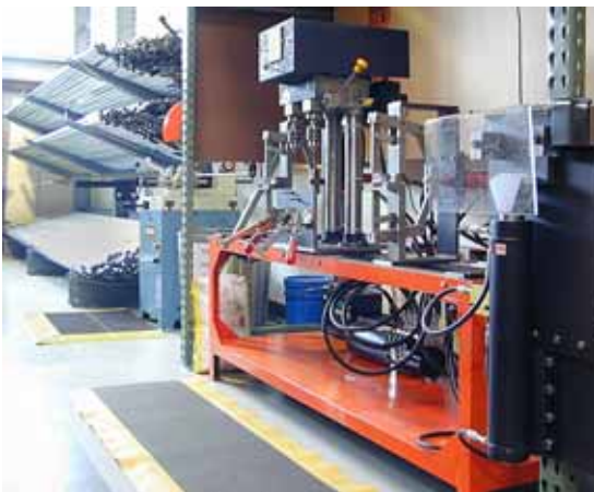
Una estación de producción mecanizada y ergonómica era diseñada para el nuevo sistema de doble-pivote innovativo, el 2P.
